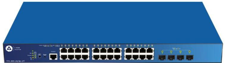
Управляемый L2 коммутатор ТГК-300-24/4д-2П оснащен 24 портами 10/100/1000Base-T с поддержкой PoE и 4 портами 1000Base-X SFP и предназначен преимущественно для использования в сетях Metro Ethernet.
